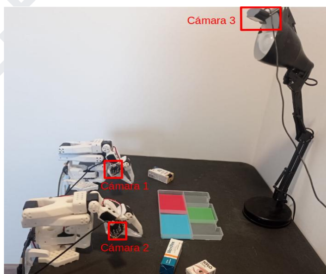
Figura 1. Configuración del entorno experimental con cámaras instaladas en brazos robóticos y vista superior.
