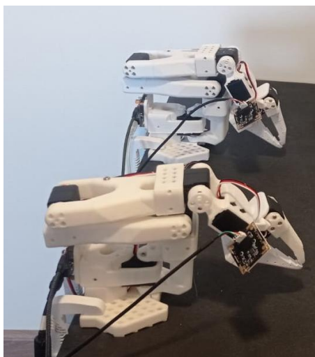
Figura 2: Vista del sistema BISO ARM-100 (dos brazos coordinados; 12 GDL en total)
